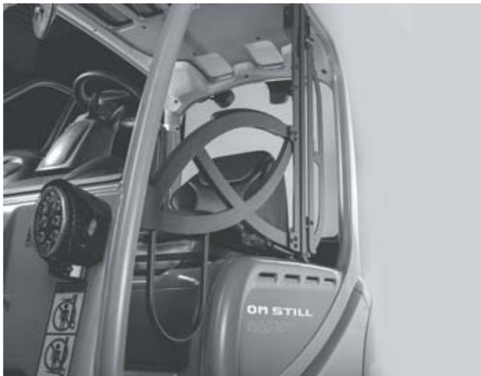
Sistema di ritenuta del conducente IWS
